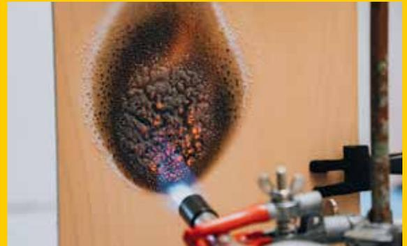
ADLER Pyrolan Beschichtungen verbessern das **Brandverhalten** wesentlich. Damit schaffen sie ein sicheres Wohngefühl und ermöglichen eine breite Verwendung von Holz- und Holzwerkstoffe als Baustoff unter Brandschutzauflagen.
