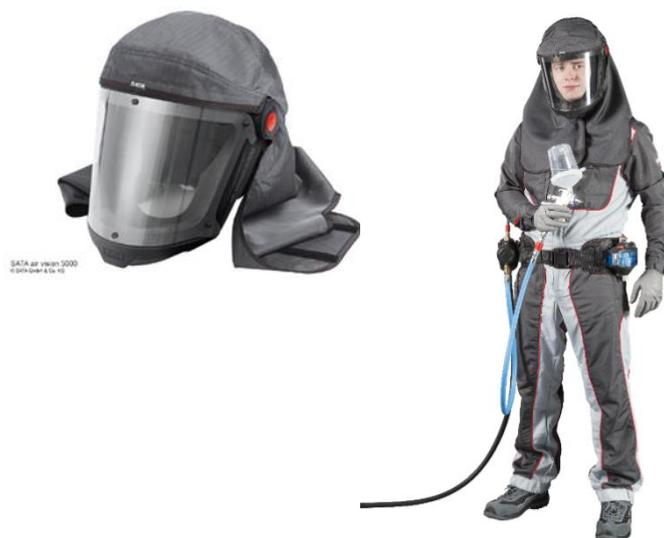
**Abb.1.4:** links: Haube für ein Druckluft-Schlauchgerät; rechts: vollständige PSA: Druckluft-Schlauchgerät nach EN 14594 der Klasse 3 mit Haube, Schutzbrille, Chemikalienschutzanzug (Typ 5) und Handschuhen. Der Druckluftschlauch wird am Gürtel angeschlossen und versorgt die Halbmaske und die Spritzpistole mit Luft.
